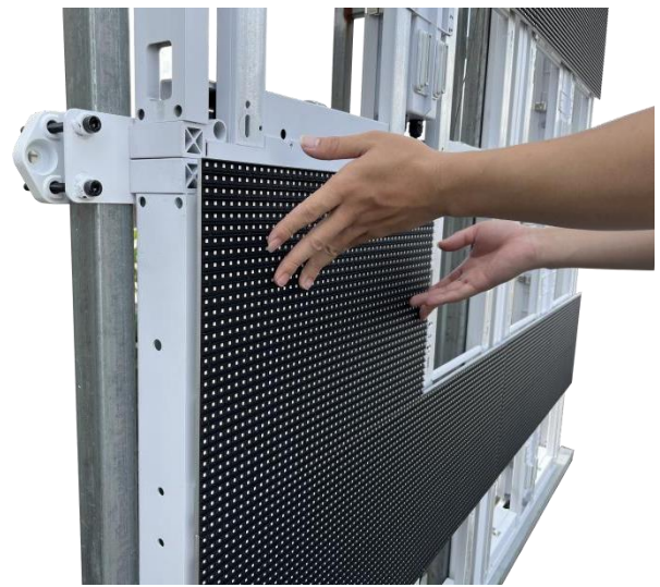
23) Install modules onto the cabinet.
